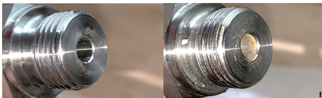
Figure V-8 Photos des anodes A) neuve et B) après service.
